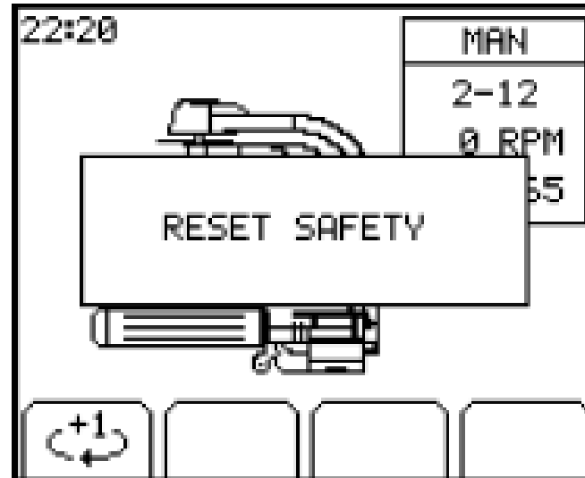
Sicherheitsarm wurde ausgelöst
