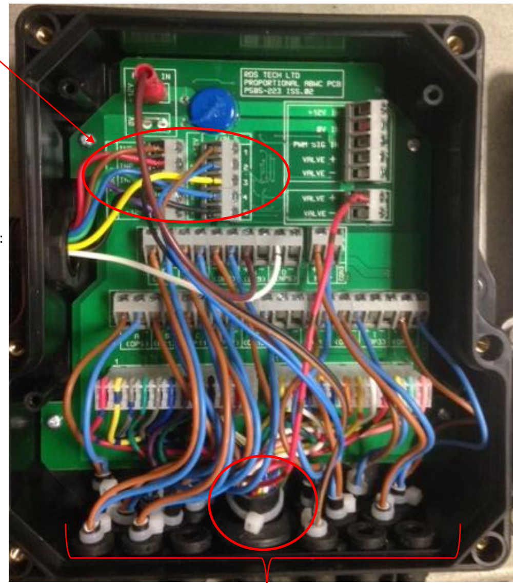
Kabel, die zum Magneten gehen und RDS Kabel von der Box rot eingekreist
